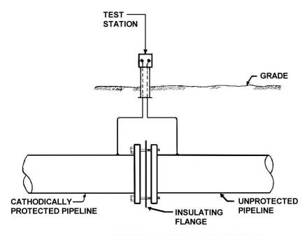
METHOD #1 - TESTING UNDERGROUND INSULATING JOINT
